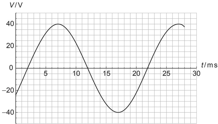
El número de espiras en la bobina primaria es 600. El valor máximo del voltaje en la bobina secundaria es de 120V.
